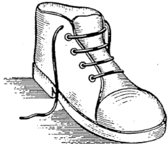
PUNTERA DE ACERO DE 1,8 mm. DE ESPESOR PLANTILLA DE ACERO DE 0,50 mm. DE ESPESOR. PUNTERA DE GOMA EXTERIOR.
